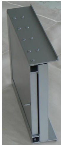
Filtr podstawowy z wsuniętym kompletem filtrów (np. w teście AEC przy zmianie grubości obiektu i napięciu lampy powyżej 100 kV)
